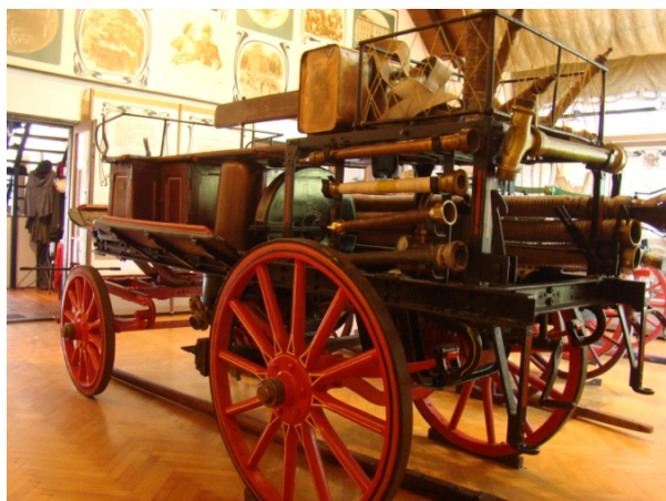
Az 1900-as évek elején még egy darabig lóvontatású fecskendőköt használtak, a kézi szivattyúk helyét azonban már kezdték felváltani a benzinmotor meghajtású vízszivattyúk. A képeken látható Köhler-féle fecskendős kocsira Csonka-féle benzinmotoros szivattyút szereltek (vörsi Tűzoltó Múzeum)
