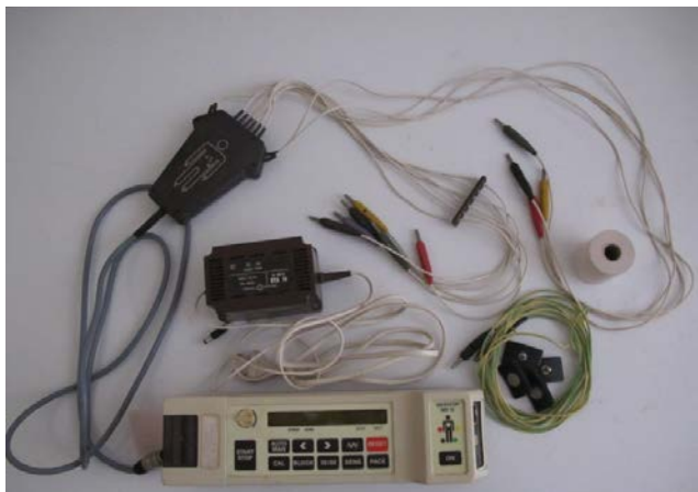
Medicor MR 12-es, egycsatornás EKG készülék. (Fotó: www.alkupiac.hu )
